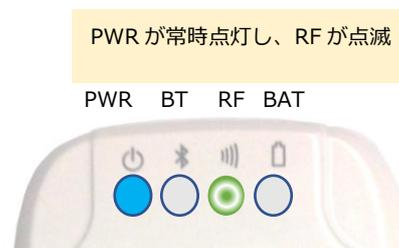
図 8-18 Dragon\_BLE カード待受け (リアルタイムモード・USB 接続)
