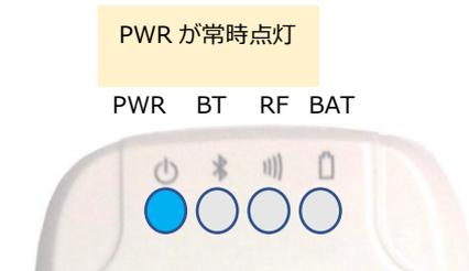
図 8-17 Dragon\_BLE - USB 接続時 LED
